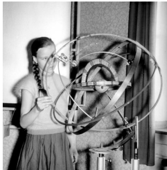
Schülerin am Máng'schen Universalapparat - einem Instrument zur Darstellung der wichtigsten Großkreise der Himmelskugel
