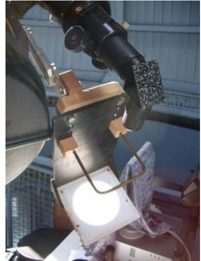
Das Sonnenbild auf dem Projektionsschirm. Aus Platzgründen wird der Strahlengang mit einem Zenitprisma um 90^\circ umgelenkt.
