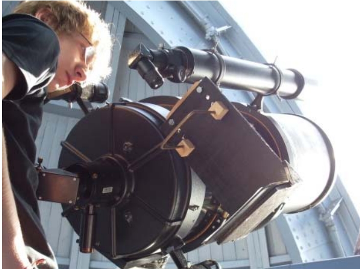
Sonnenbeobachtung auf der Sternwarte Recklinghausen. Das Hauptteleskop mit dem Sonnenfilter ermöglicht die direkte Beobachtung. Mit dem Refraktor (im Bild oben) wird die Sonne auf einen Schirm (rechts unten) projiziert.
