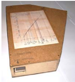
Selbstgebautes Gitterspektroskop (das Gitter ist vorne links zu sehen).
